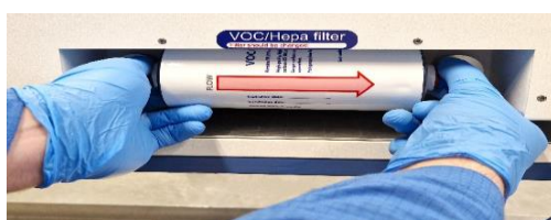
Figura 12.2 Procedura de introducere și îndepărtare a filtrului COV/HEPA
